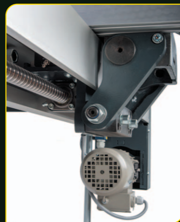
Motorický posuv podélného pravítka NC 3 osy
